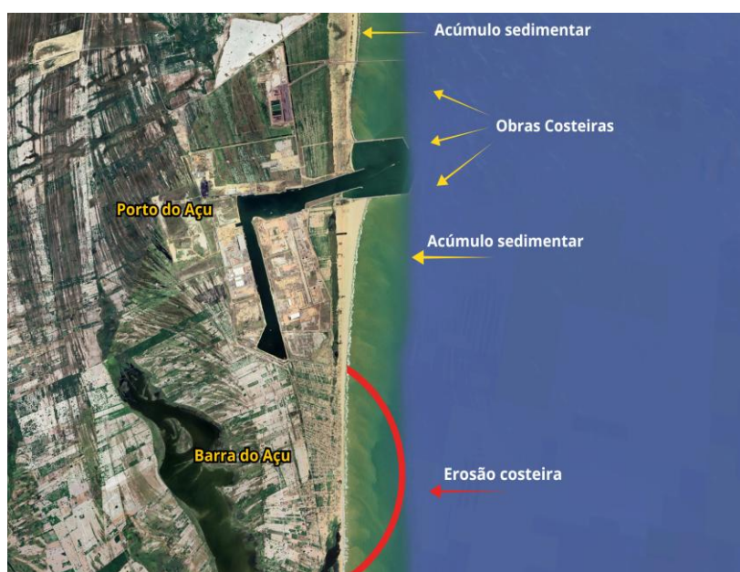
Figura 3: Processo de deposição e supressão sedimentar no litoral do V Distrito
